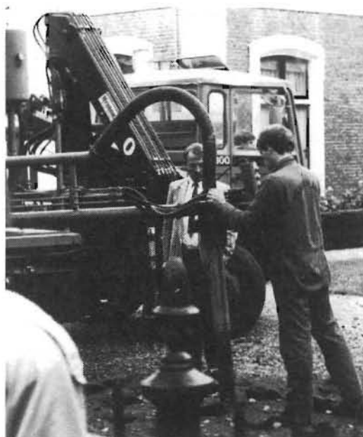
Met zware machines worden meststoffen in de grond tussen de boomwortels gepompt. Foto: Hans Gierveld
