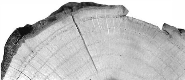
alb. 5 Kringpong hout, in dit geval van eik, kenmerkt zich door ringen opgebouwd uit grote houtvaten. Afgrenslingslaag 4 is op deze afbeelding te zien als het donkere laagje buiten de jongste jaarring
